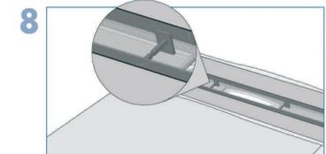
8 Rahmen einsetzen. Die Höhenverstellung erfolgt durch die Stellfüße. Nach Fliesenverlegung erfolgt das Einlegen der befestigten Abdeckung.
