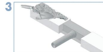
3 Klebemörtel auf der Unterseite des Rinnenkörpers auftragen.
