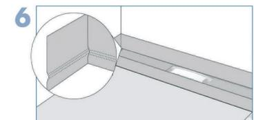
6 Dichtmanschette allseitig hochschlagen und Estrich mit entsprechendem Gefälle oberflächenbündig zum Rinnenkörper einbringen. Die Dichtmanschette darf nicht gespannt an die Wand geklebt werden.
