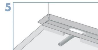
5 Nach Aushärtung des Klebemörtels das Ablaufrohr an die Hausentwässerung anschließen (1 - 2 % Gefälle). Auf Dichtheit prüfen.
