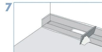
7 Randdämmstreifen abschneiden und die integrierte Dichtmanschette flächig verkleben. Bei wandbündigem Einbau ist die Dichtmanschette nicht gespannt anzukleben. Die dichte Einklebung der Dichtmanschette sowie aller Innen- und Außenecken und Dichtbänder erfolgt mit Dichtkleber, bis der Duschbereich mit allen Wand- und Bodenflächen komplett eingedichtet ist.
