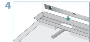
4 Rinnenkörper auf den ebenen, sauberen, tragfähigen, nicht elastischen Untergrund setzen und ausrichten.
